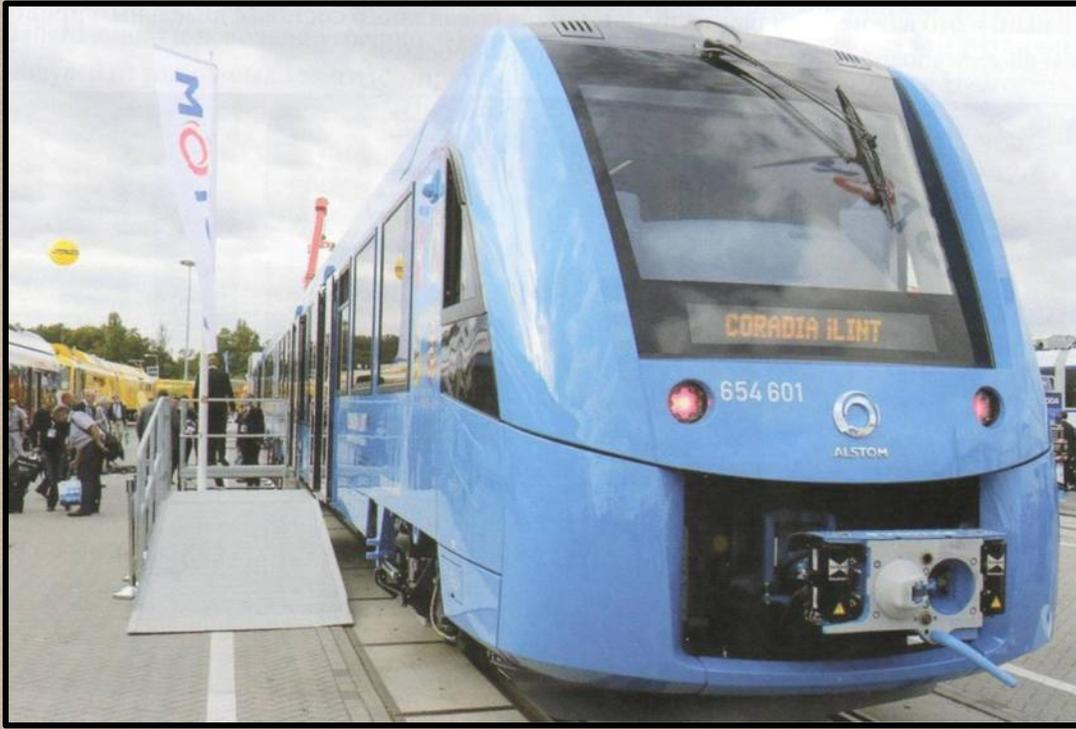
Corradia iLint, первый пассажирский поезд на водородных топливных элементах, запущенный в серийное производство
